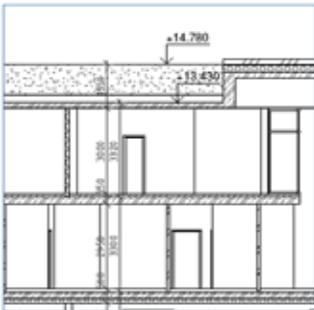
*Obr. č. 20: Pozdĺžny rez poškodenou časťou – detail (hrúbka strešných vrstiev vegetačnej plochej strechy =  $14,780 - 13,430 = 1,350$  m)*
