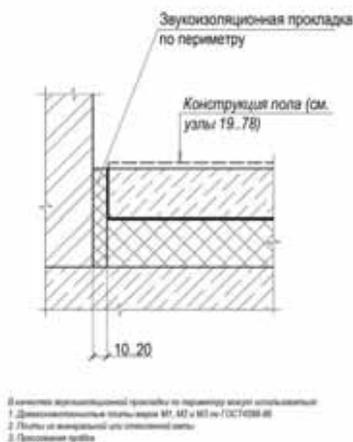
**Рисунок 4. Конструкция плавающих полов**
