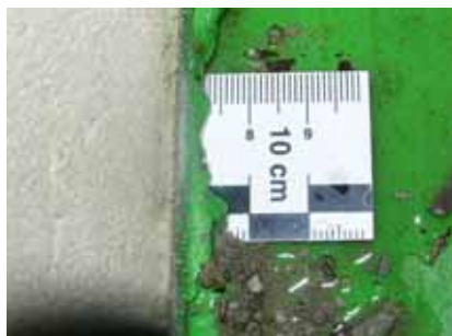
Obr. 4. Plastové měřidlo vložené v místě styku rampy s podlahou do hloubky větší než 70 mm
