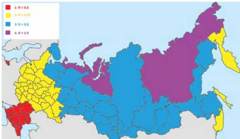
Рис.1. Условные климатические зоны территории РФ по рекомендуемым значениям приведенного сопротивления теплопередаче используемых светопрозрачных конструкций.
