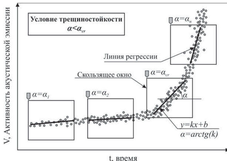
Рис. 1. Основные элементы анализа потока акустико-эмиссионных импульсов
